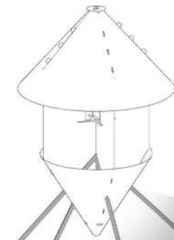
۵. سپس پایه‌ها را به صورت کشویی از سوراخ‌های مثلث شکل قیف کوچک‌تر به گونه‌ای رد کرده که داخل تیغه‌های وسط تا انتهای مطابق تصویر چفت شوند(می‌توانید جهت تسهیل کار، سازه را به صورت برعکس بر روی یک سطح خالی رنگ قرار دهید، سپس پایه‌ها را متصل کنید).
